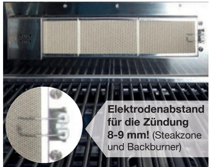
Elektrodenabstand für die Zündung 8-9 mm! (Steakzone und Backburner)
