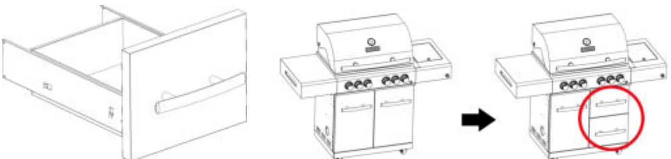
1. Demontieren Sie die Stützwinkel an an der rechten Seite sowie die Türscharniere und überprüfen Sie die korrekte Montage der Türmittelstrebe
